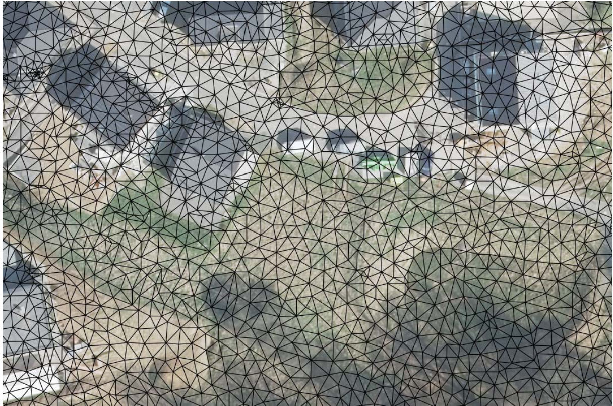
Abbildung 4: Detaildarstellung des Rechennetzes
